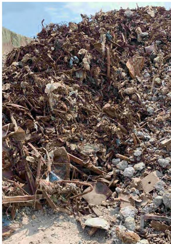
**Abb. 15: Grober Eisenschrott aus Schlackeaufbereitung (© Scherer & Kohl GmbH)**
