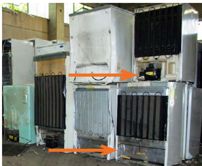
Abb. 3: Kühlgeräte, mit und ohne Kompressor (© LfU)
