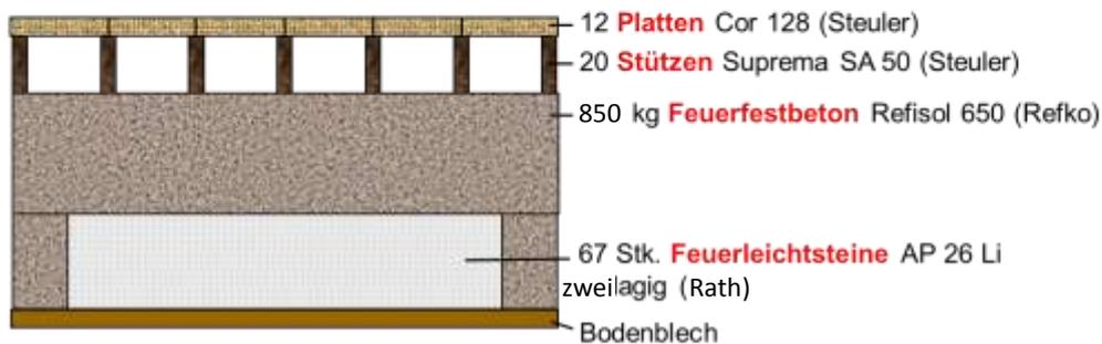
Bild 12 a: Aufbau Ofenwagen, alte Bauweise
