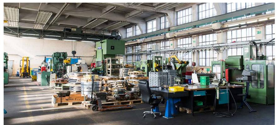
Auf Stanzautomaten mit Schließkräften von 20 bis 250 Tonnen werden Stanzteile in Folgeverbundwerkzeugen und Einzelwerkzeugen in der Größenordnung von 0,1 bis 5 mm hergestellt. Feinschneidteile in Größen von 3 bis 10 mm werden auf Feinschneidpressen mit einer Schließkraft von bis zu 160 Tonnen gefertigt. Benötigte Werkzeuge für die Bearbeitungsmaschinen und Anlagen werden vorwiegend selbst konstruiert und gebaut.
