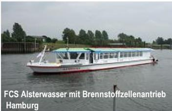
FCS Alsterwasser mit Brennstoffzellenantrieb
